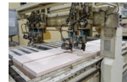
組み立て(断熱材)
