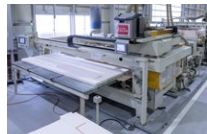
断熱材カット
